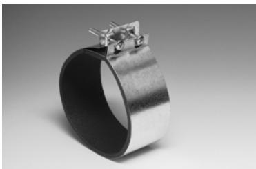
Diese **Befestigungsmanschette** dient zum Verbinden eines Ventilators mit einem kreisförmigen Luftkanal mit gleichem Durchmesser. Gleichzeitig absorbiert sie Erschütterungen von dem Ventilator auf den Luftschaft. Der Vorteil dieser Art des Anschlußes ist die Möglichkeit, den Ventilator jederzeit für einen Austausch oder Reparatur aus dem Luftkanalsystem heraus zu nehmen.
